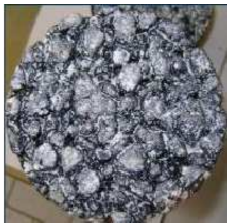
(d) Potongan konstruksi perkerasan lentur dengan lapisan semen TiO 2
